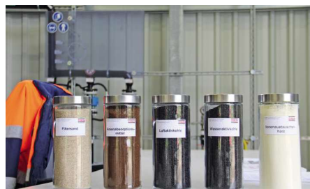
Diese und andere Materialien kommen bei der Reinigung des Grundwassers zum Einsatz.
